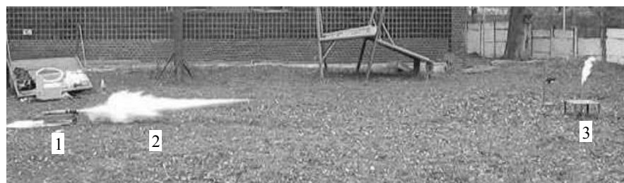
Рис. 6. Средняя фаза распространения импульсной струи жидкости.
